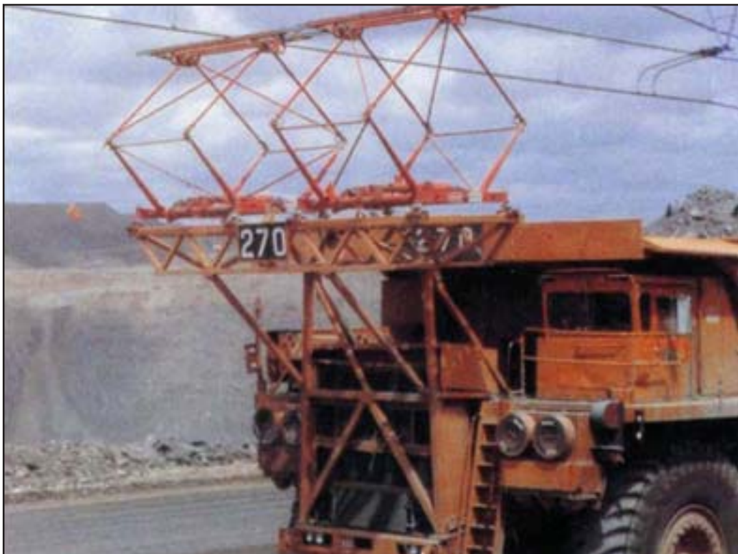
PHOTO 42 : Camion à rouage diesel-électrique tiré par un système de trolley.
