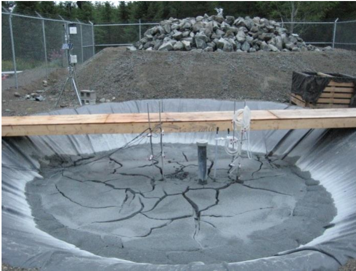
Figure 2-1 : Cellules expérimentales – Cellule des résidus en avant-plan, cellule de stérile (dunite serpentinisée) en arrière-plan. Le diamètre des cellules est de 5 m.
