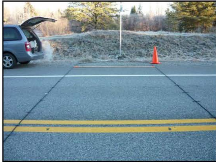
Figure 4 – Tubes installés sur la route 111 à Launay
