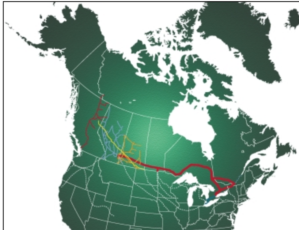
Figure 3.6 Réseaux de pipelines canadiens de gaz naturel
