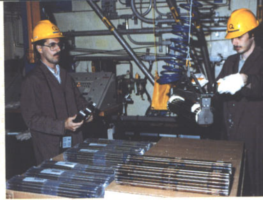
Les grappes de combustible neuves sont disposées manuellement sur un appareil qui les déplace jusqu'à la machine à chargement dans le réacteur.
