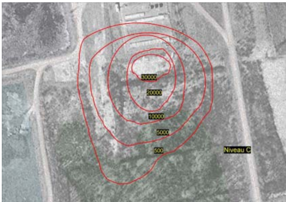
Figure 2: Activité moyenne en Bq/L de tritium mesurée dans les eaux du niveau C au sud de l'ASDR
