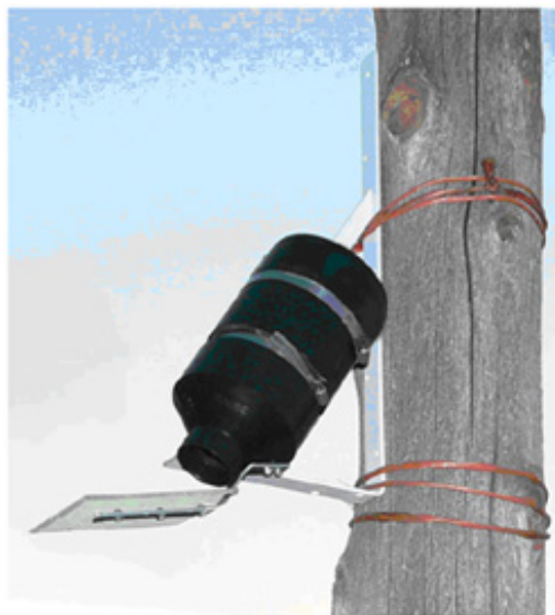
Figure 1 Dispositif contenant un détecteur Anabat
