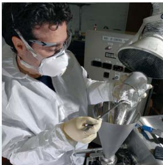
Travaux en cours à l'IREQ sur les sels fondus destinés aux batteries au lithium-ion
