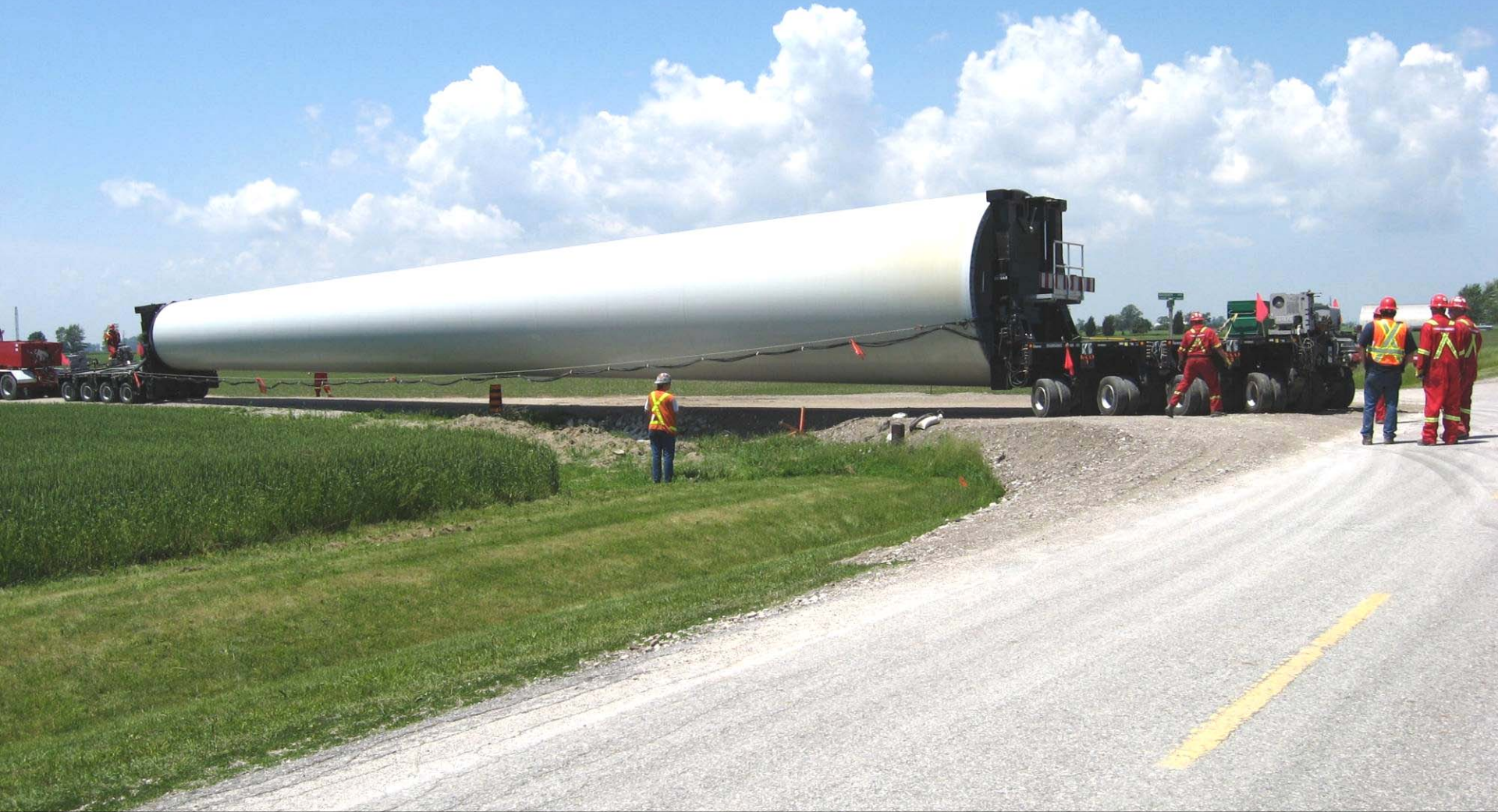
Livraison d'une section de tour
