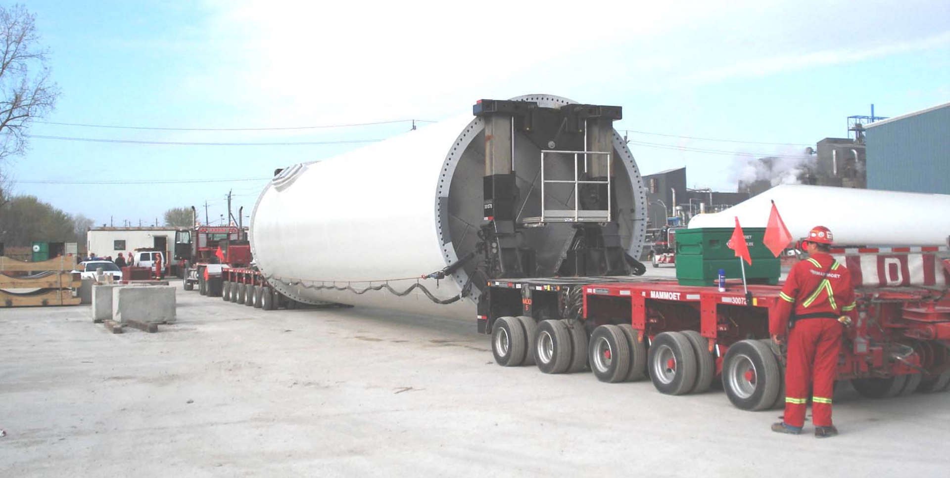
Livraison d'une section d'éolienne
