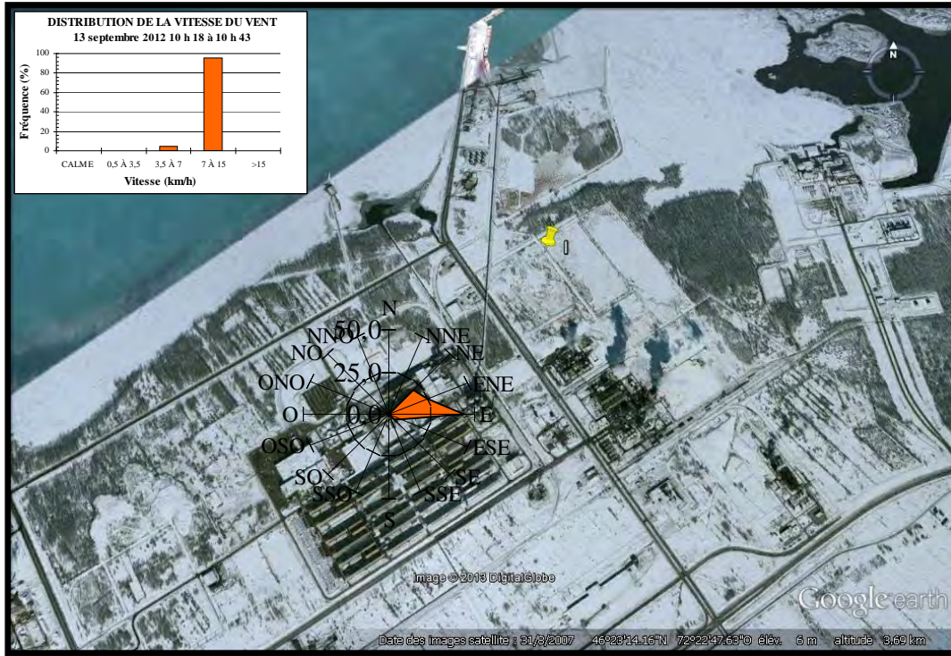
Figure 6 : Fréquence de l'orientation des émissions – Aluminerie de Bécancour inc. – 13 septembre 2012 de 16 h 46 à 17 h 15
