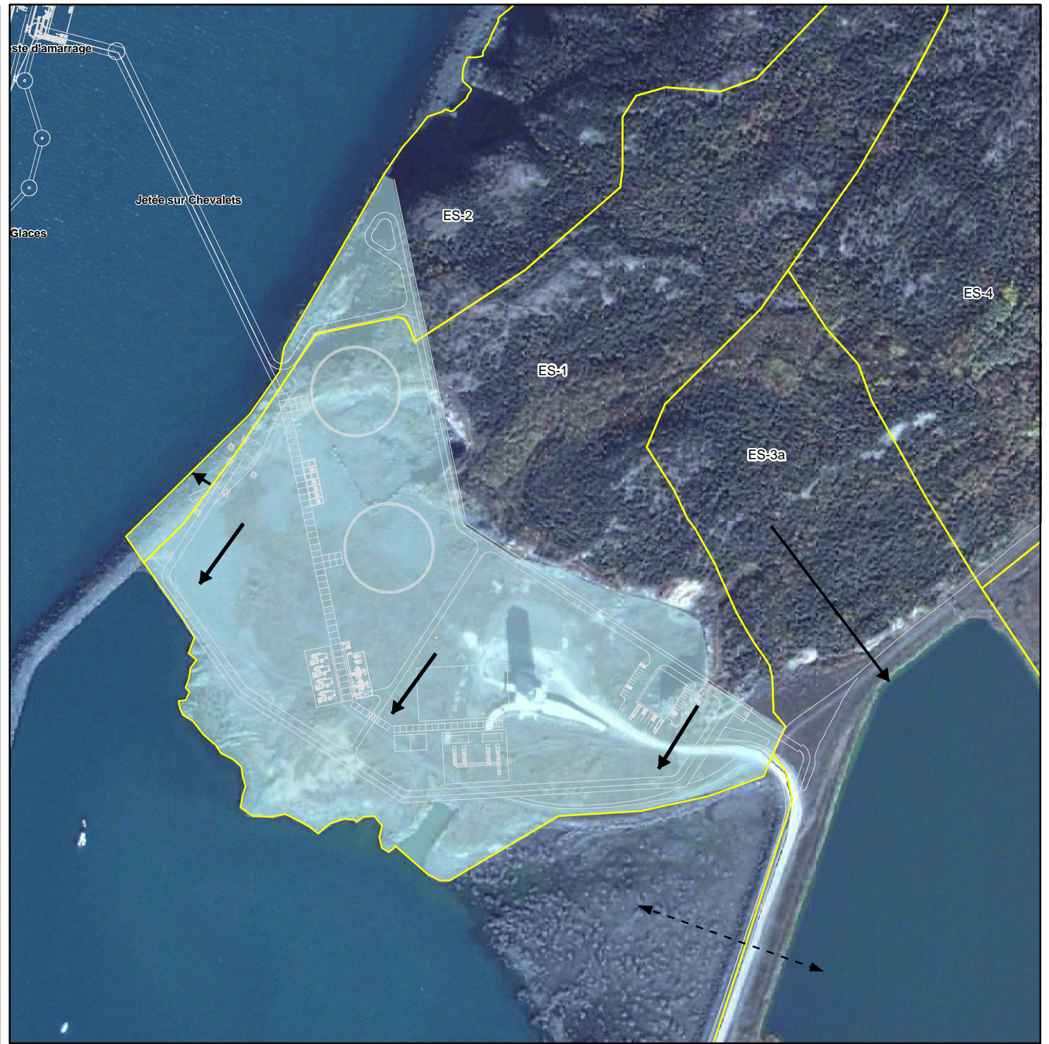
Drainage proposé pour le site du terminal
