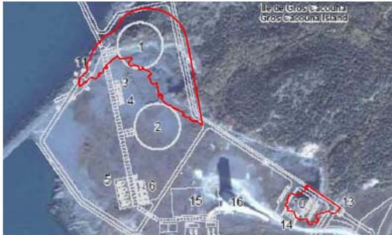
1. Figure Q-023-2 Périmètre représentant la zone à excaver par forage et dynamitage
