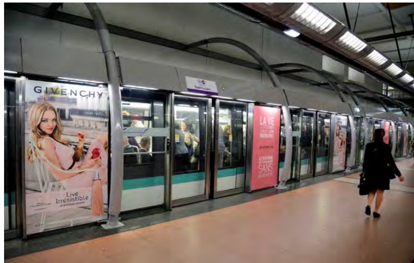
Figure 7-44 : Exemple de portes palières
