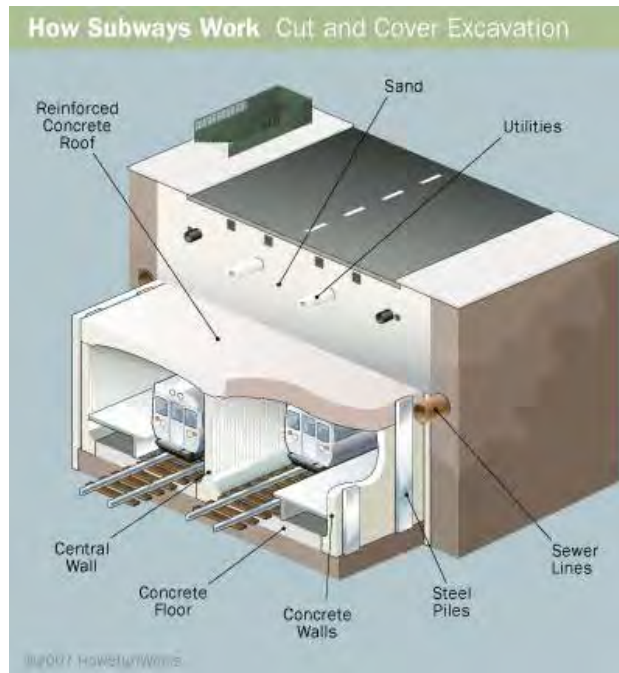
Figure 7-40 : Exemple de configuration en tranchée couverte (1)
