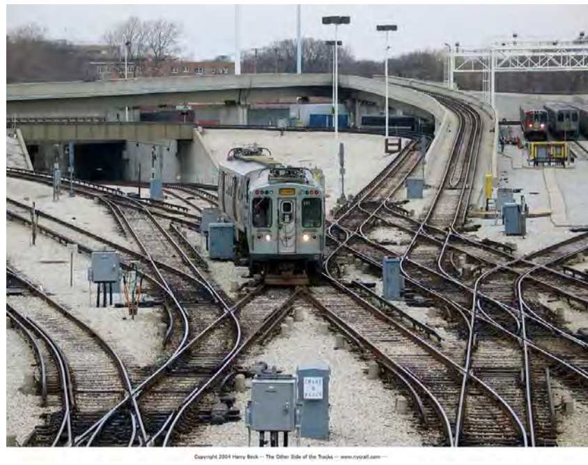
Figure 7-13 : Exemple aiguillage (ETC)
