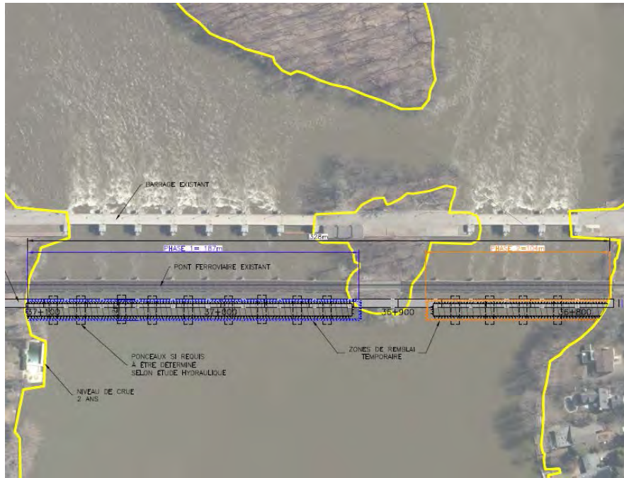
Figure 7-56 : Sections de ponts enjambant la rivière des Mille-Îles
