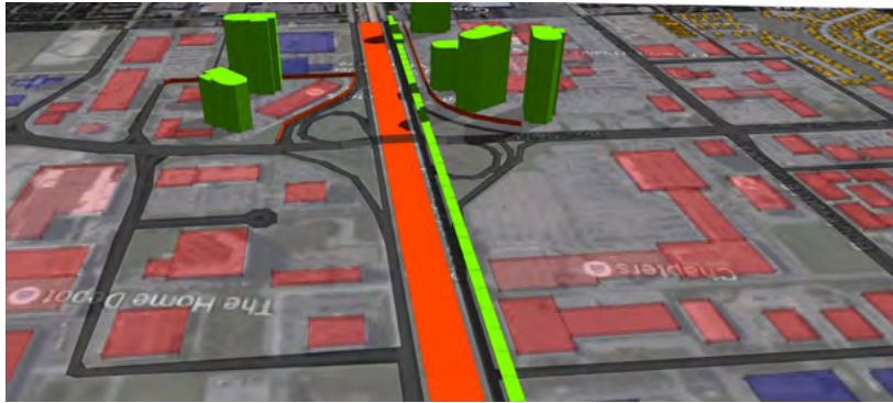
Figure 54) Mitigation des contraintes autoroutières à l'aide de murs anti-bruit, Imagine Lachine-Est 2016
