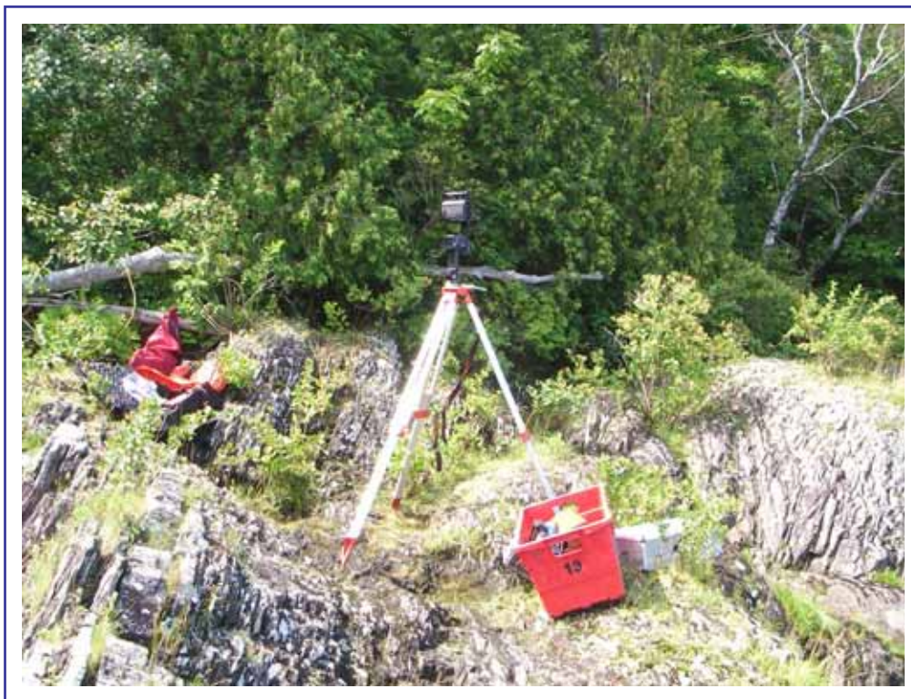
PHOTO 1 — Télémètre laser (Laser Technologie inc. ; modèle : Impulse 200XL avec option MapStar)
