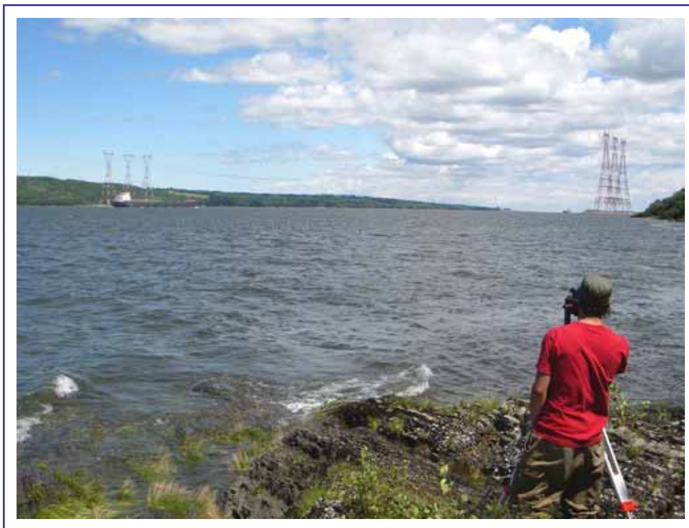
PHOTO 2 — L'observateur positionné en rive et mesurant le positionnement d'un navire
