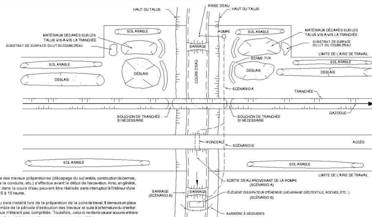
Notes: - L'ensemble des travaux préparatoires (décapage du sol arable, construction de bermes, soudage de la conduite, etc.) s'effectue avant le début de l'excavation. Ainsi, en général, les travaux dans le cours d'eau peuvent être réalisés sans interruption à l'intérieur d'une période de 6 à 15 heures.
