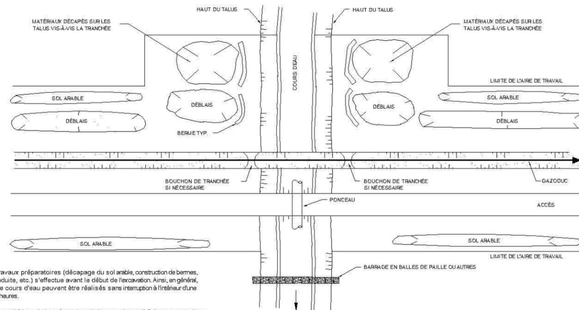
Notes: - L'ensemble des travaux préparatoires (décapage du sol arable, construction de barmes, soudage de la conduite, etc.) s'effectue avant le début de l'excavation. Ainsi, en général, les travaux dans le cours d'eau peuvent être réalisés sans interruption à l'intérieur d'une période de 6 à 15 heures.
