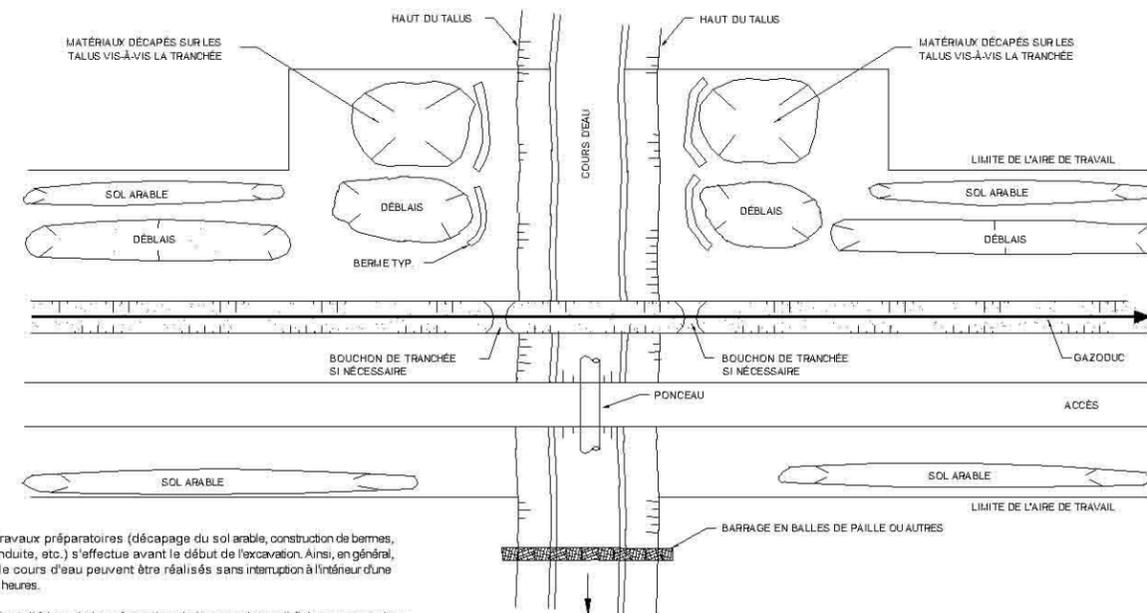
Notes: - L'ensemble des travaux préparatoires (décapage du sol arable, construction de barmes, soudage de la conduite, etc.) s'effectue avant le début de l'excavation. Ainsi, en général, les travaux dans le cours d'eau peuvent être réalisés sans interruption à l'intérieur d'une période de 6 à 15 heures.
