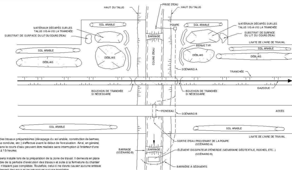
Notes: - L'ensemble des travaux préparatoires (décapage du sol arable, construction de bernes, soudage de la conduite, etc.) s'effectue avant le début de l'excavation. Ainsi, en général, les travaux dans le cours d'eau peuvent être réalisés sans interruption à l'intérieur d'une période de 6 à 15 heures.
