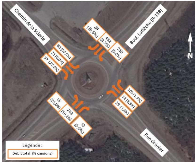
Figure 39 Carrefour route 138 / chemin de la Scierie – Débits de circulation existants à l'heure de pointe du soir (16 h 15 – 17 h 15)
