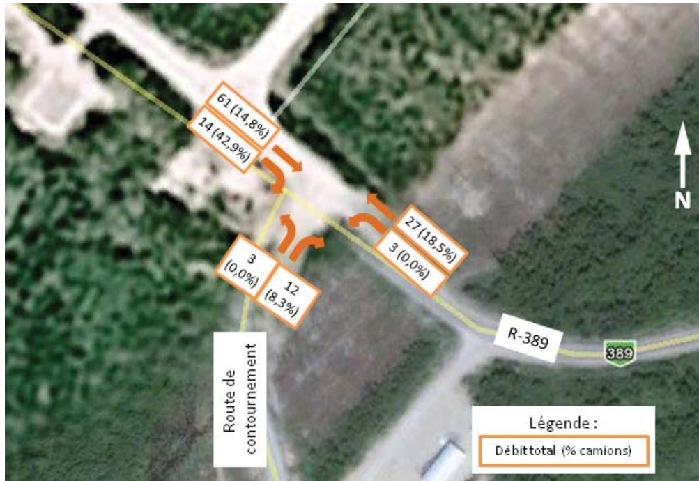
Figure 28 Carrefour route de contournement / route 389 – Débits de circulation existants à l'heure de pointe (16 h 45 – 17 h 45)
