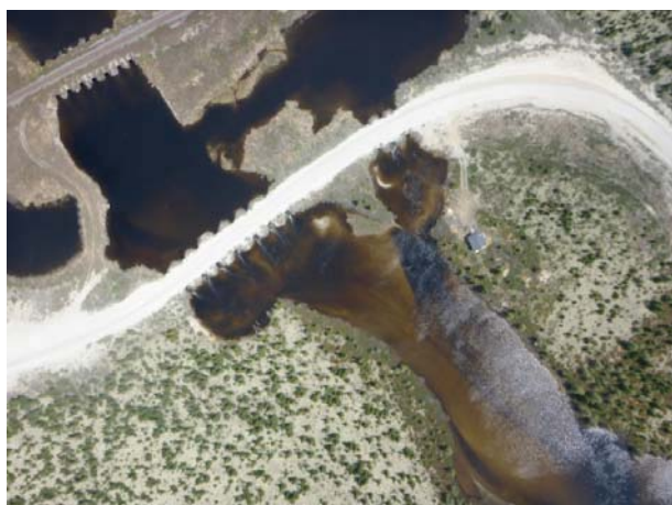
Photo 2.25 km 488 : Petite rivière Manicouagan - Sept ponceaux TTOG 2 500 mm en parallèle (P-08906 à P-08911)
