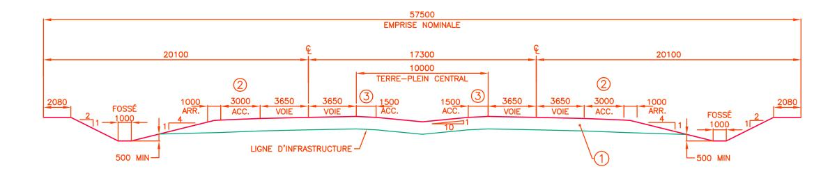
1 - ÉPAISSEUR TOTALE DE LA STRUCTURE DE CHAUSSÉE UTILISÉE = 945mm 195mm D'ENROBÉS BITUMINEUX 250mm DE MATÉRIAUX GRANULAIRES MG-20 500mm DE MATÉRIAUX GRANULAIRES MG-112
