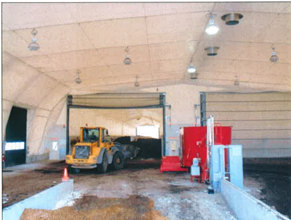
Les 6 silos couloirs sont utilisés pour les différents types de matières organiques à traiter (Boues, ICI, Résidentiel)
