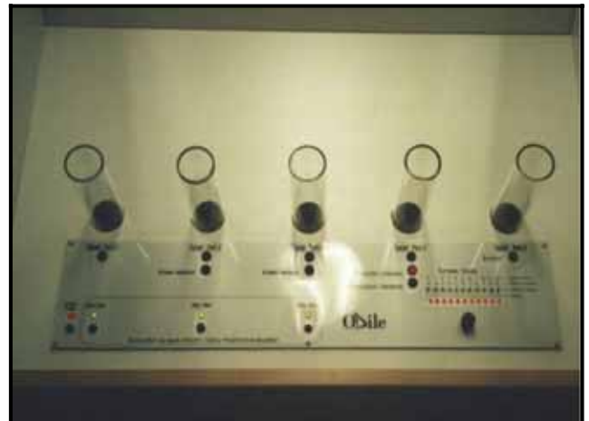
Figure 2-5 Olfactomètre à dilution dynamique : poste de flairage des odeurs
