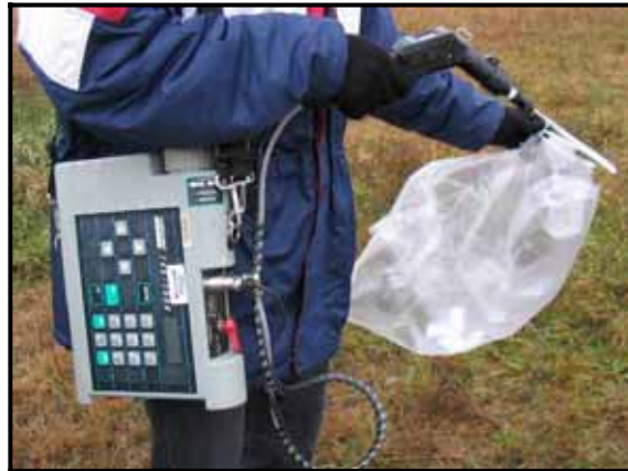
Figure 2-6 Mesures des concentrations de CH 4 avec le détecteur à ionisation de flamme TVA1000B
