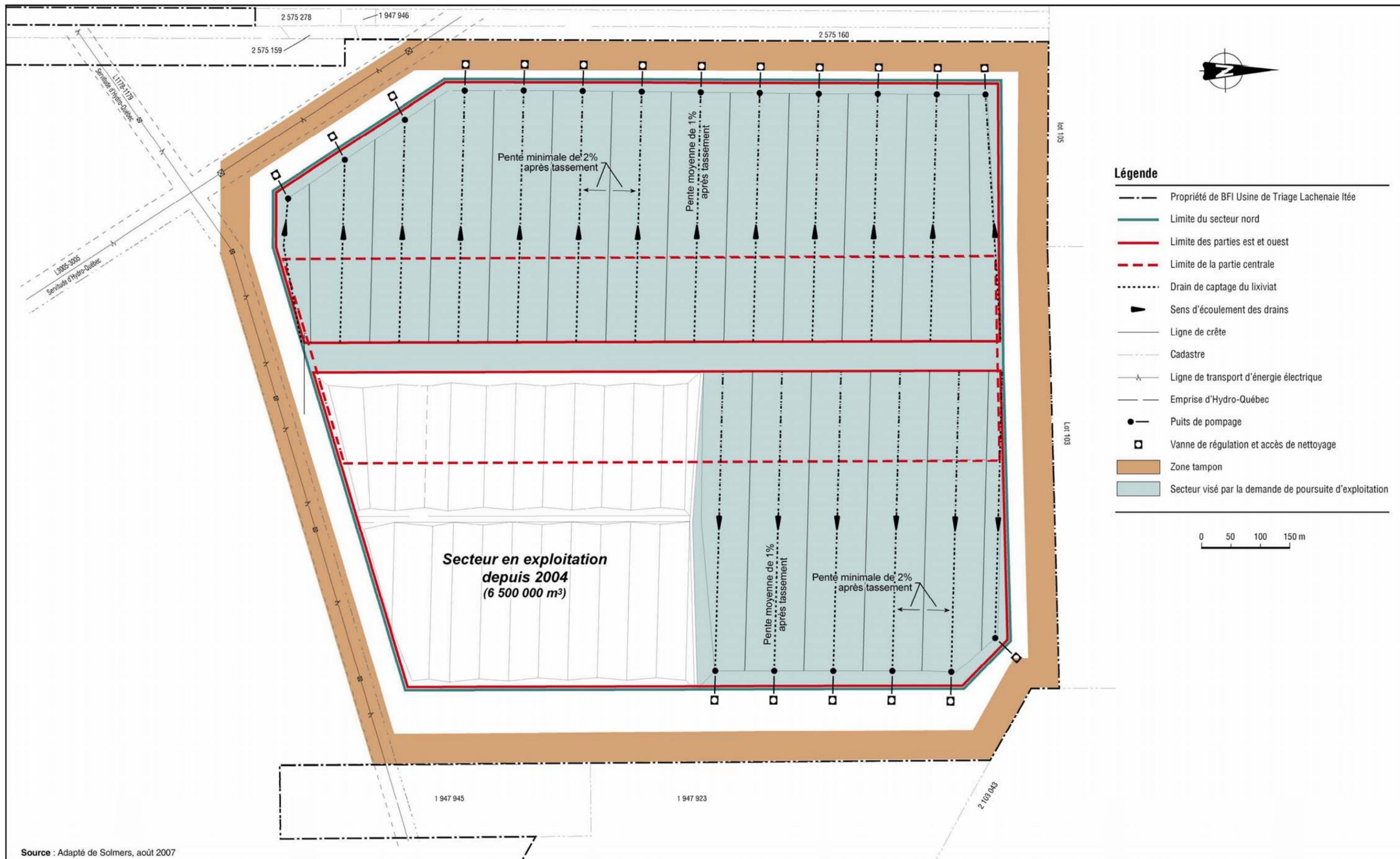
Figure 2.6 : Système de traitement du lixiviat
