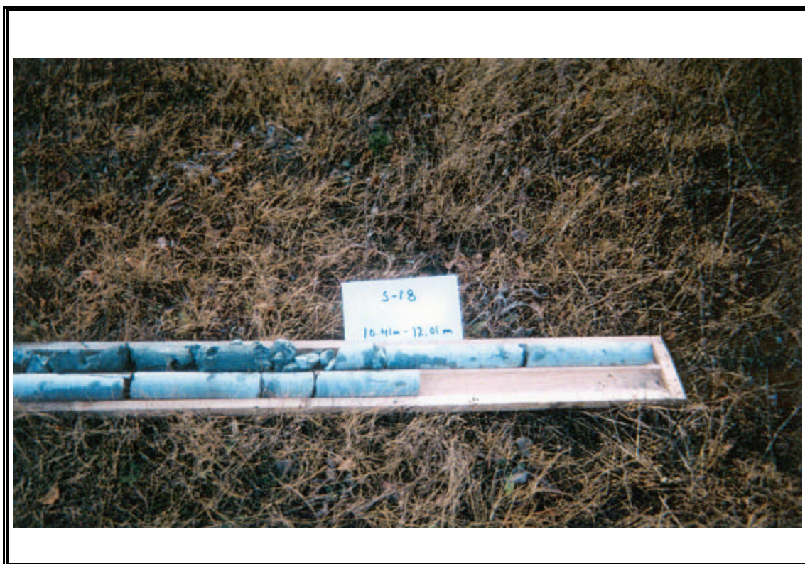
PHOTO 6 : Roc carotté site de forage S-18, profondeur de 10,41 m à 12,01 m.
