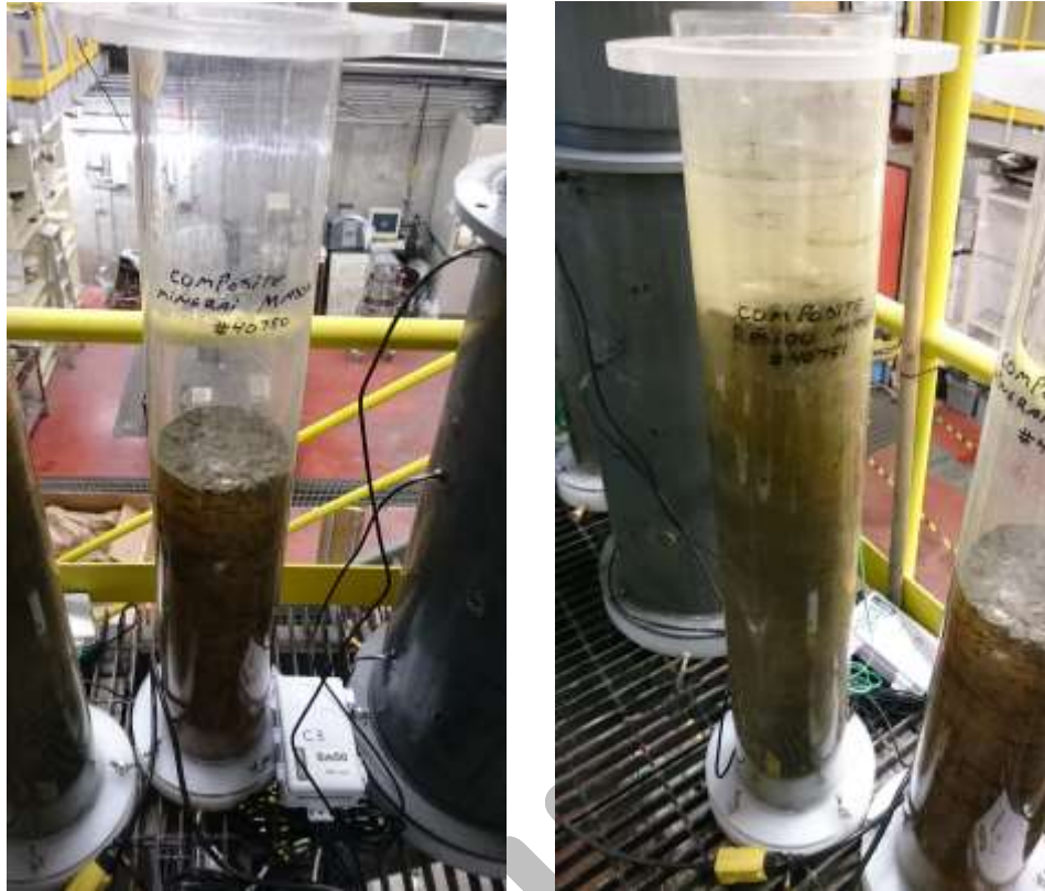
Figure 1 : Montages pour les colonnes de minerai (gauche) et de résidus (droite)
