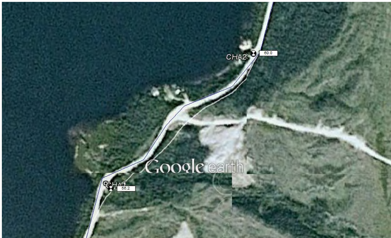
Figure 9-1 : Vue aérienne des chalets 1 et 2 et niveaux de bruit ( L_{Aeq,1h} ) causés par le trafic atteint lors du passage de huit (8) camions
