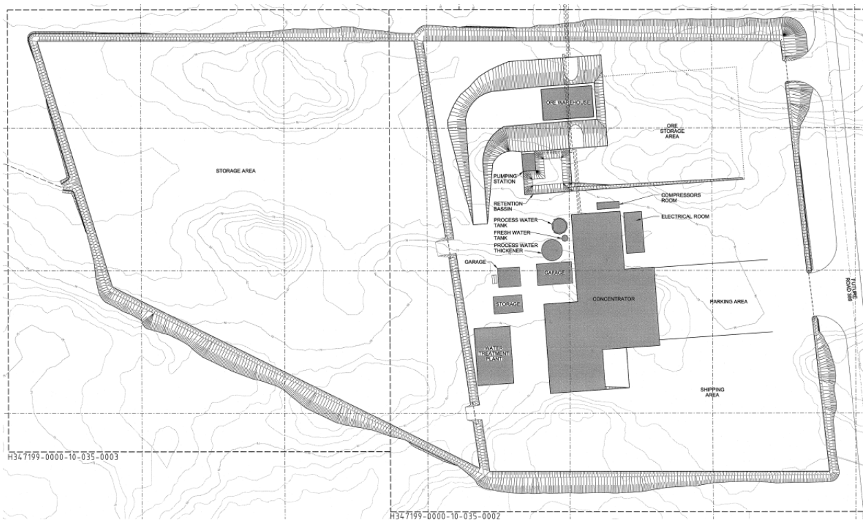
Figure 3-3 : Concept préliminaire de contrôle des eaux de surface au concentrateur (tiré de H347199-0000-10-035-0001)
