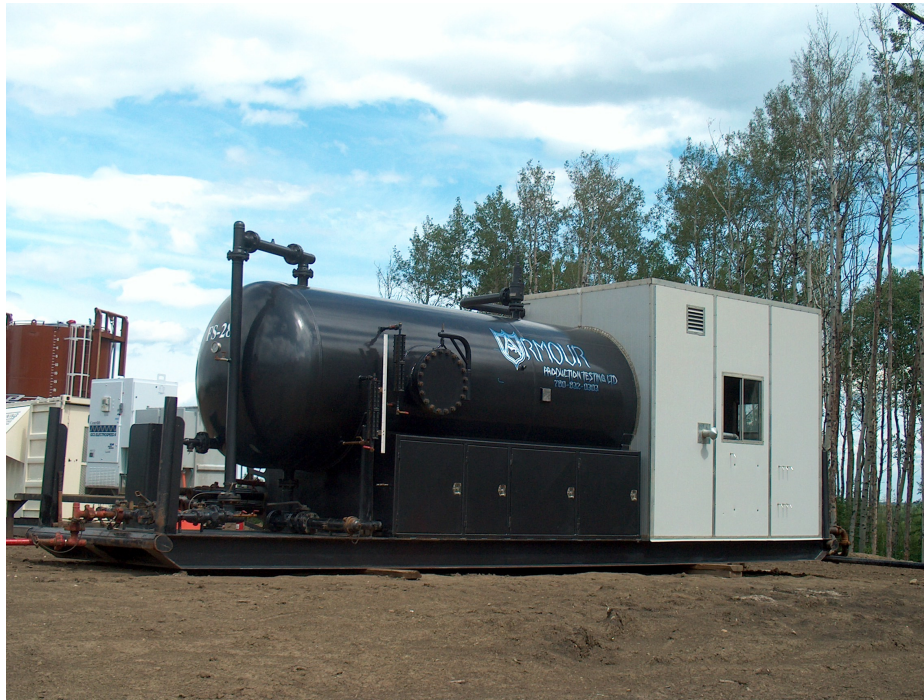
Appareil de test portable - utilisé pour mesurer et séparer l'eau et le gaz
