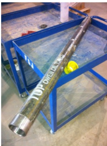
Canon de perforation chargé avant le tir
