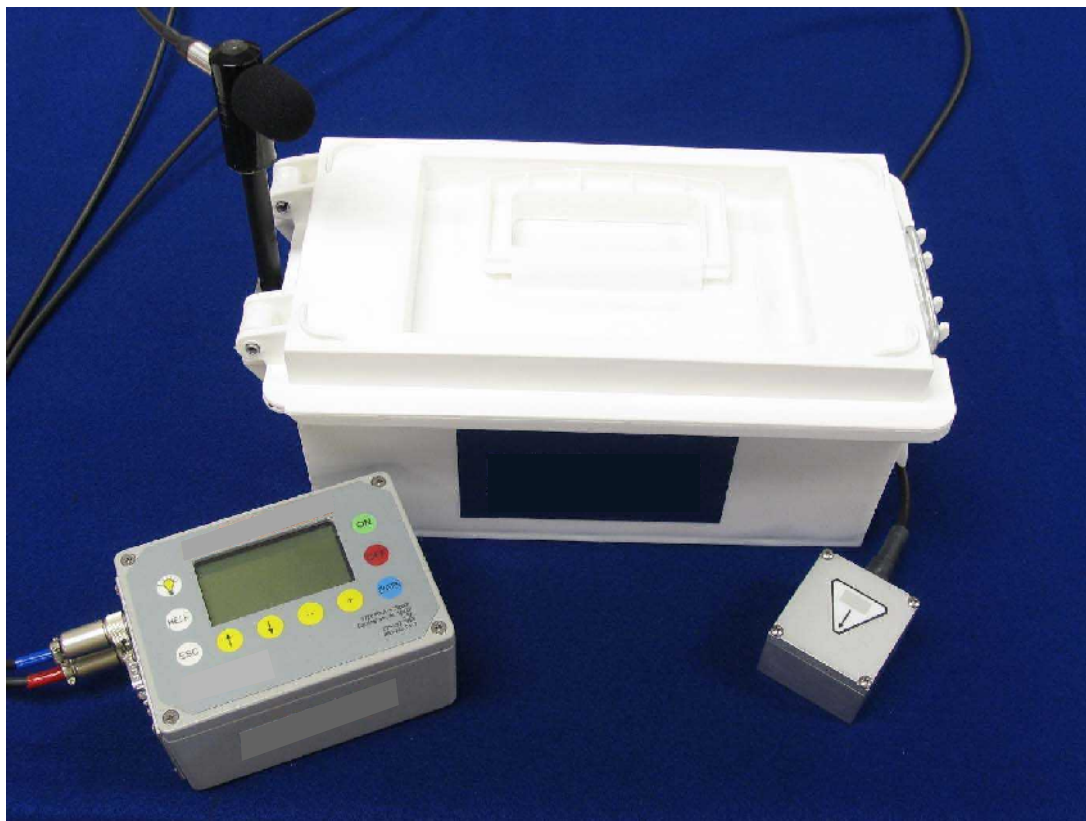
Photo 8 – Sismographe numérique avec capteur 3D
