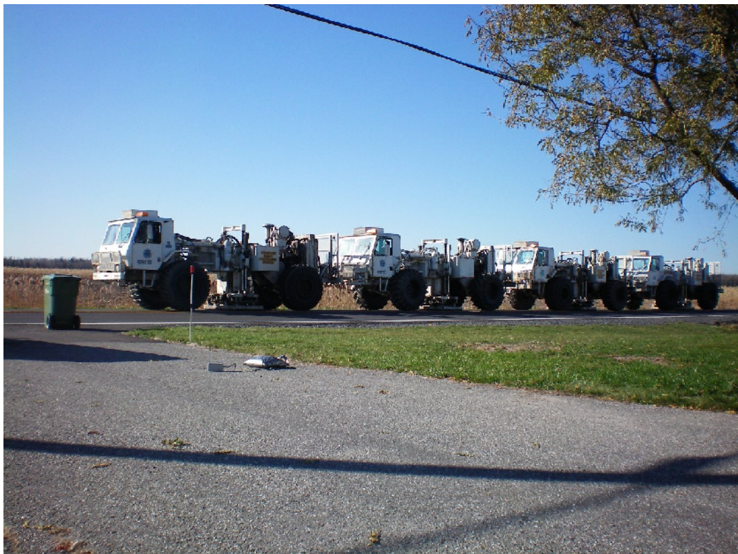
Photo 4 – Mesures de vibrations des camions vibrateurs sur route de campagne
