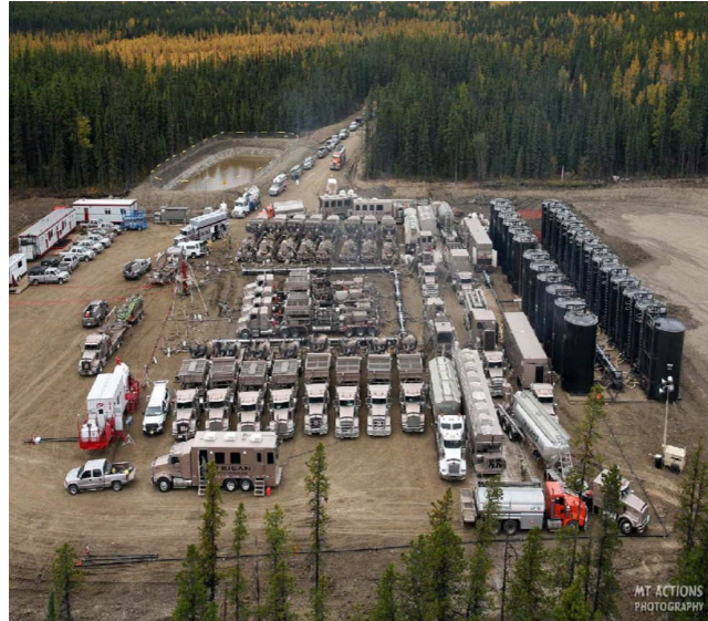
Figure 11 - Fracturation hydraulique dans un puits horizontal
