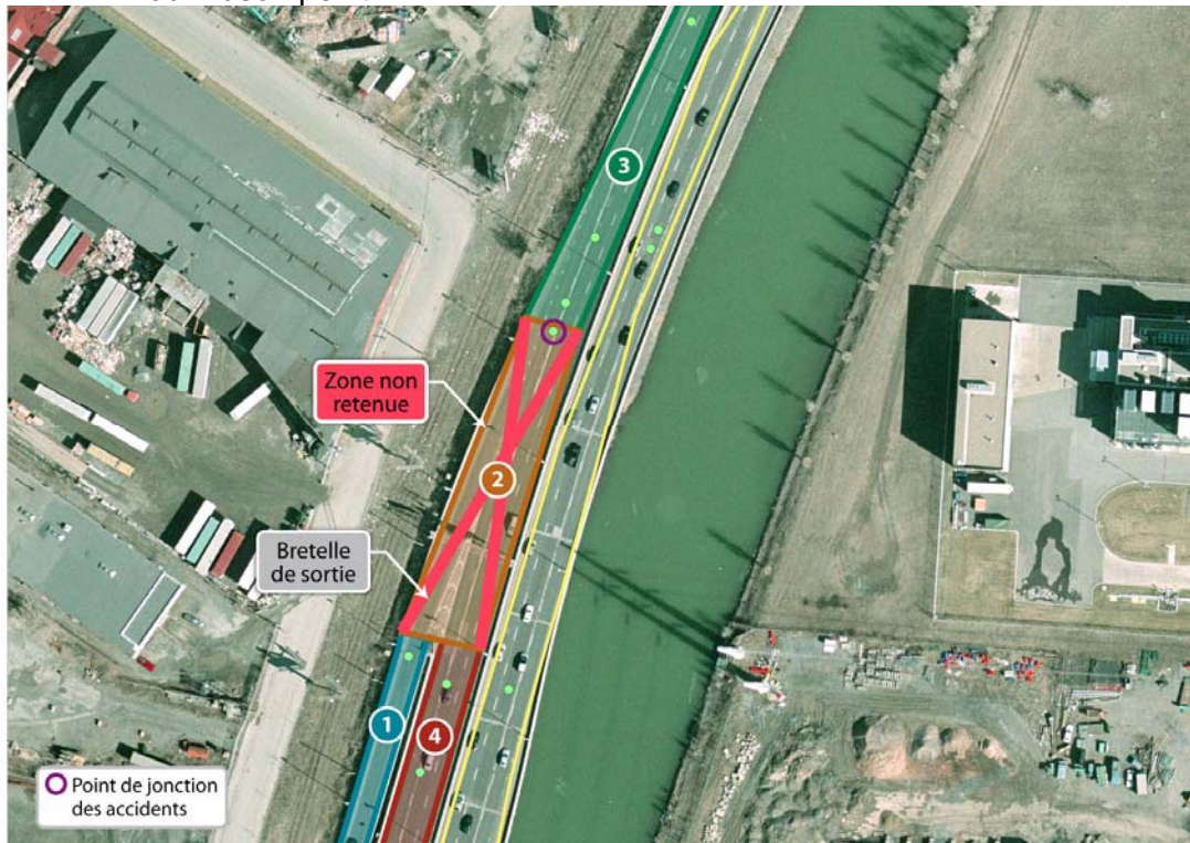
Figure B.3 : Segmentation des unités lorsque le point de jonction se situe à l'extérieur du musoir peint
