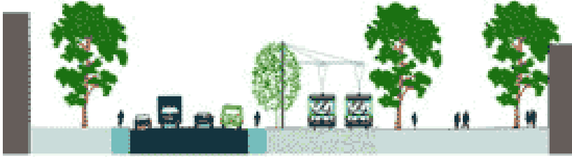
Figure 4.4 Coupe type de l'aménagement des boulevards, où le tramway est en position latérale (petite portion seulement des boulevards)
