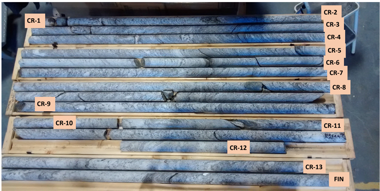
PHOTOGRAPHIE 2: Carottes de roc du forage TF-15-13 (CR-01 à CR-13)
