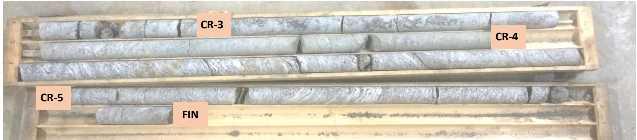
PHOTOGRAPHIE 15: Carottes de roc du forage TF-15-33 (CR-03 à CR-05)
