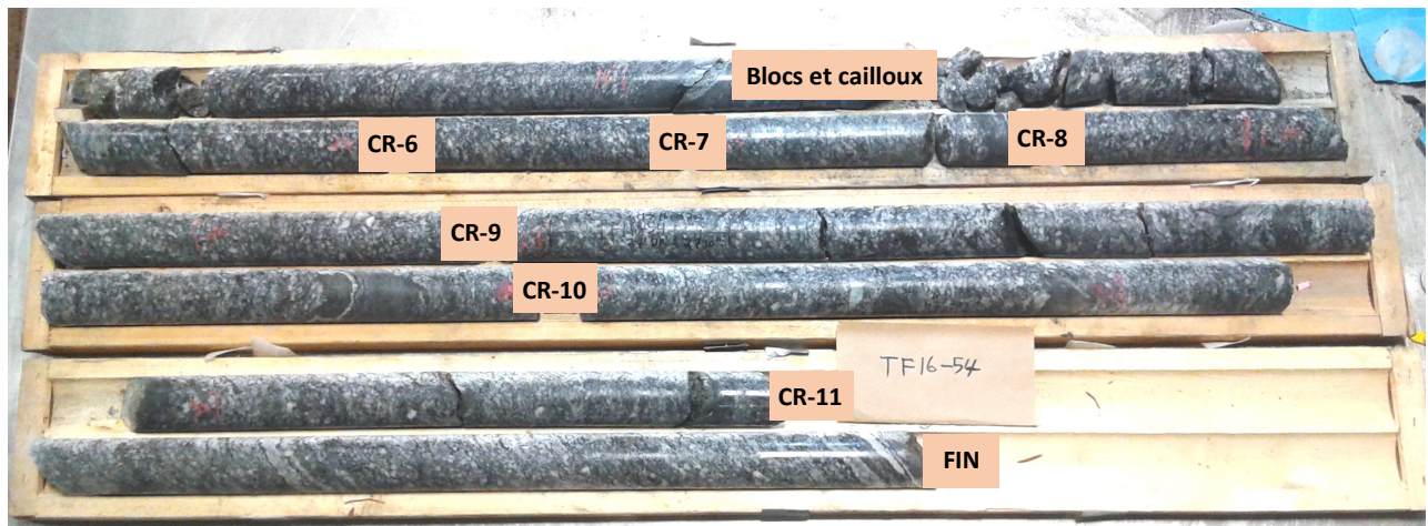
PHOTOGRAPHIE 31: Carottes de roc du forage TF-16-54 (CR-6 à CR-11)
