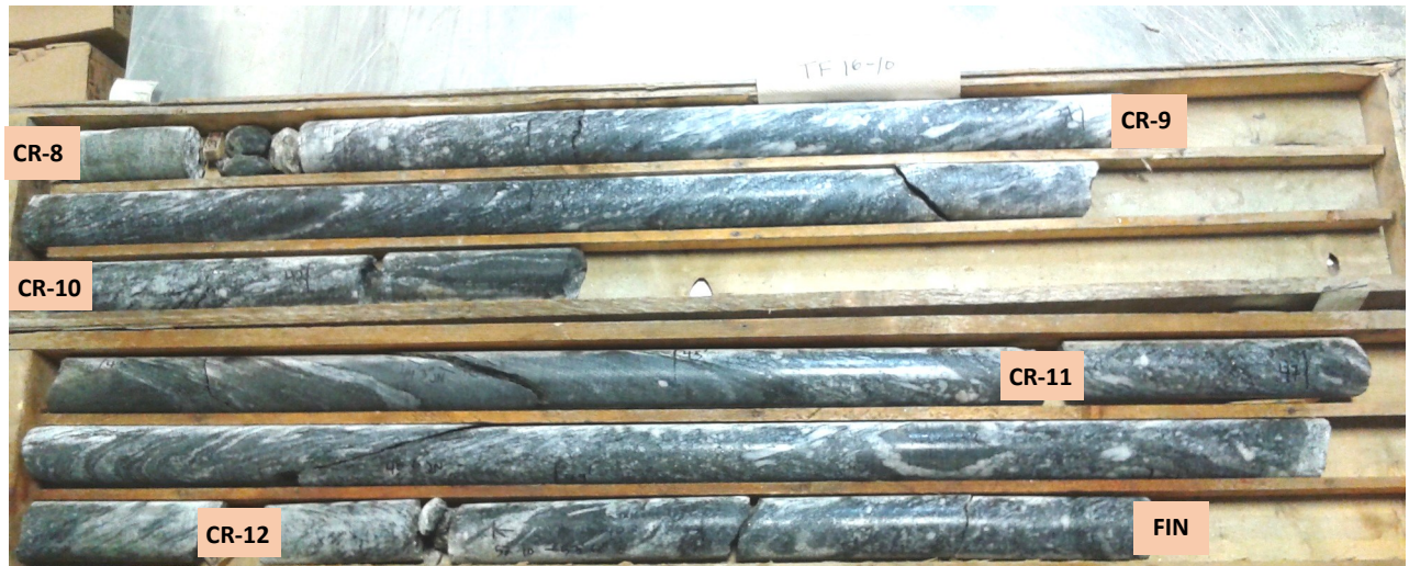
PHOTOGRAPHIE 27: Carottes de roc du forage TF-16-10 (CR-8 à CR-12)
