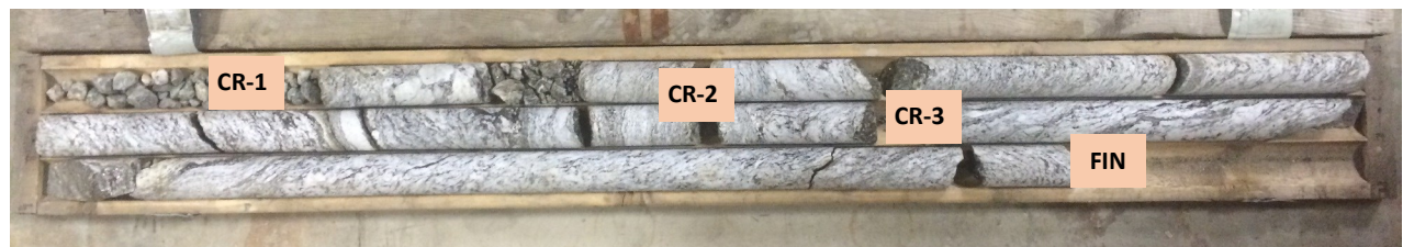
PHOTOGRAPHIE 17: Carottes de roc du forage TF-15-35 (CR-01 à CR-03)
