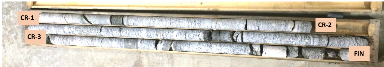
PHOTOGRAPHIE 9: Carottes de roc du forage TF-15-26 (CR-01 à CR-03)
