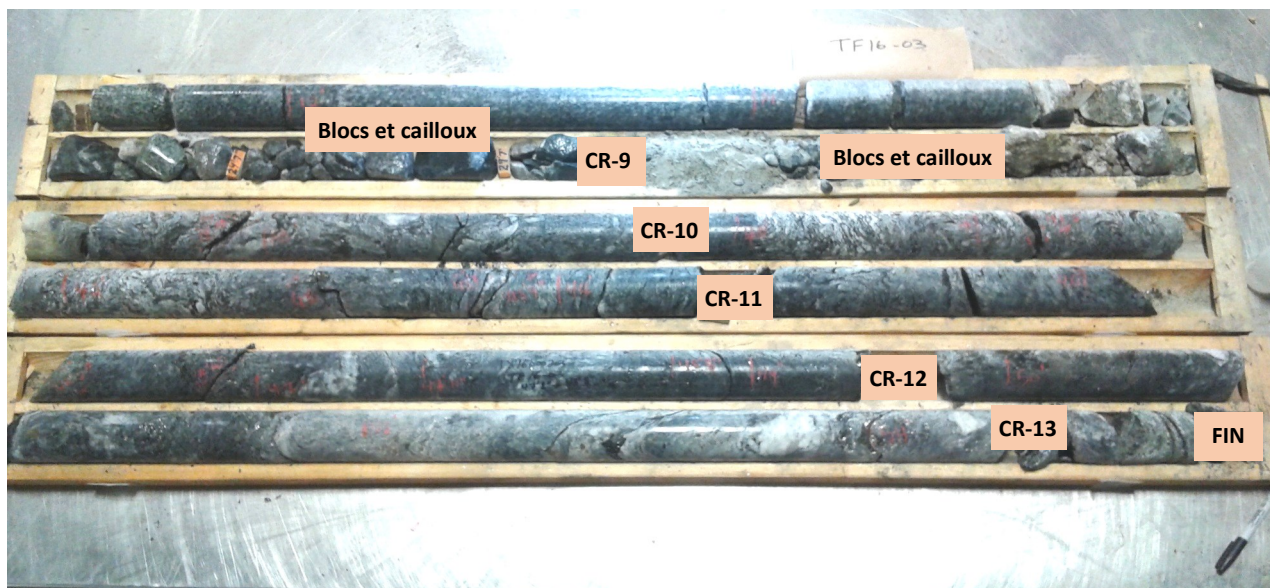
PHOTOGRAPHIE 21: Carottes de roc du forage TF-16-03 (CR-09 à CR-13)
