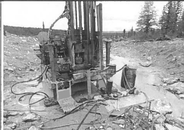
Note : Forage TF-16-59 Essais de pression avec l'obturateur. Vue ver l'Ouest
