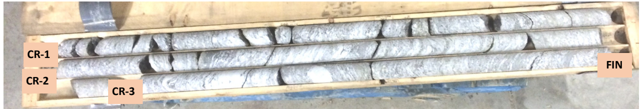
PHOTOGRAPHIE 10: Carottes de roc du forage TF-15-27 (CR-01 à CR-03)
