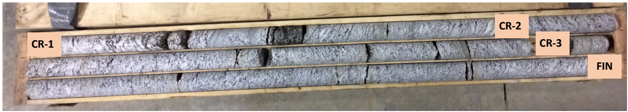
PHOTOGRAPHIE 14: Carottes de roc du forage TF-15-32 (CR-01 à CR-03)
