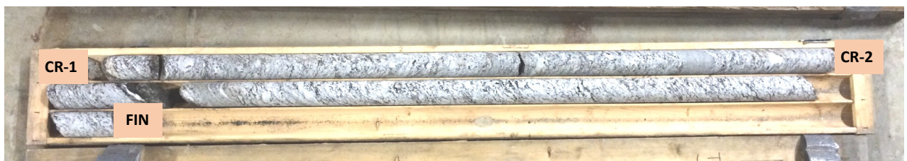
PHOTOGRAPHIE 13: Carottes de roc du forage TF-15-31 (CR-01 et CR-02)
