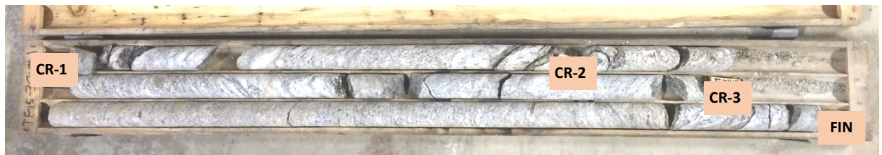
PHOTOGRAPHIE 12: Carottes de roc du forage TF-15-30 (CR-01 à CR-03)
